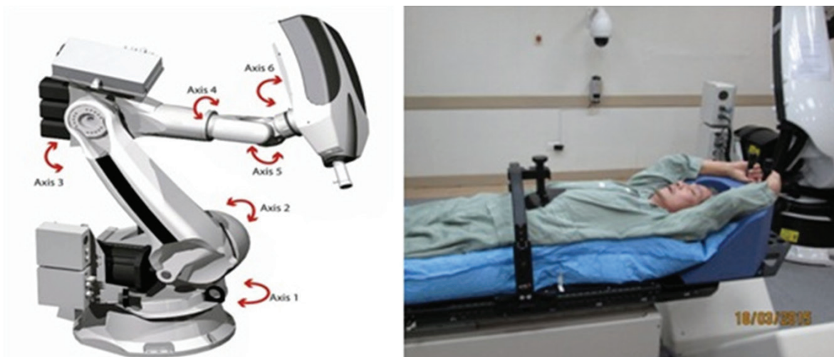
Hình 2. Cánh tay Robot của hệ thống CyberKnife với 6 khớp quay.
